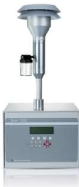
4 pav. Automatinis aplinkos oro teršalų KD 10 analizatorius
