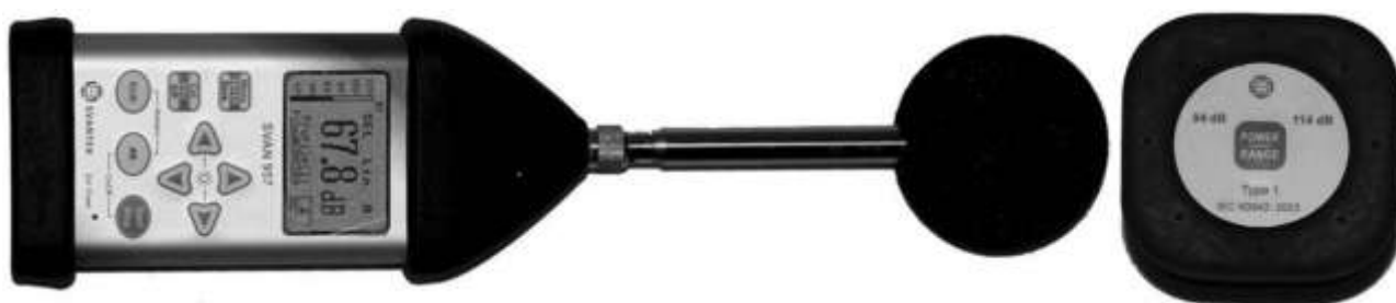
8 pav. SVAN 957 Triukšmo ir vibracijos matuoklis.
